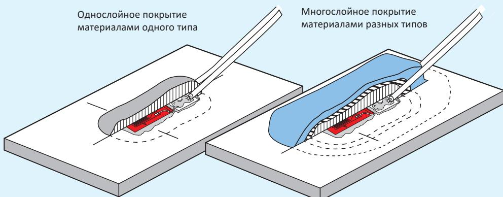
Тип необходимого покрытия и способ применения зависят от среды, в которой используется тензорезистор. В целом, если покрытия одного типа недостаточно, для защиты тензорезисторов можно применять несколько покрытий. В TML покрытие, наносимое непосредственно на поверхность
